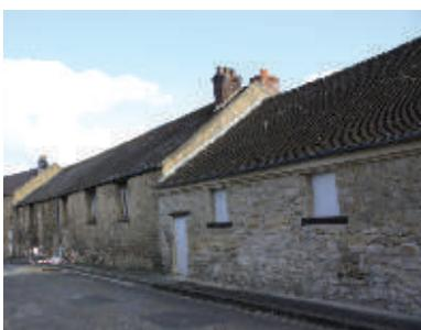
La tuile plate en terre cuite, le moellon calcaire enduit et la pierre de taille constituent les matériaux de construction des maisons rurales. Les rares modénatures tels que corniches, bandeaux, chaînages, encadrements, sont en plâtre.
