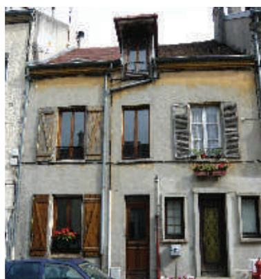
Plus hautes que larges, les fenêtres laissent entre elles des parties verticales de mur appelées trumeaux. Le comble est parfois éclairé par un châssis à tabatière ou par une petite lucarne à capucine ou à engranger (gerbière).
