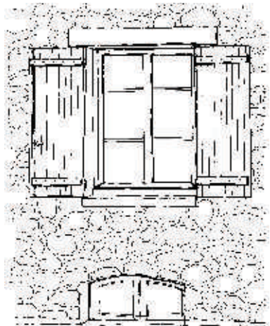
Fenêtre traditionnelle de rez-de-chaussée avec soupirail en soubassement
